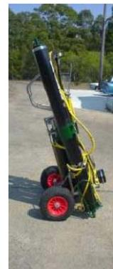
1200薄煤层钻孔机带有2个管架支腿，钻孔机得以360°转动。
