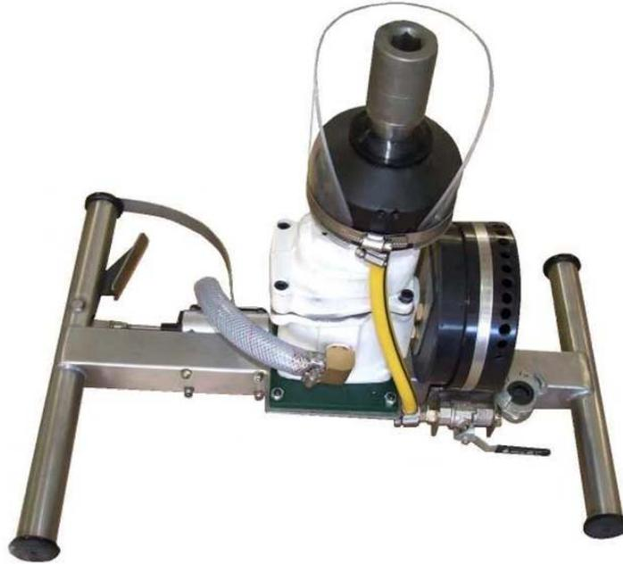
H字型大钻机是具有高转矩的机械装置，配有规格为70mm 或 95mm 的 SGI 发动机和齿轮箱。齿轮箱的齿轮齿数比为14:39，顶端装配有一个对开径向上止推轴承，以承受钻孔时的末端载荷。
