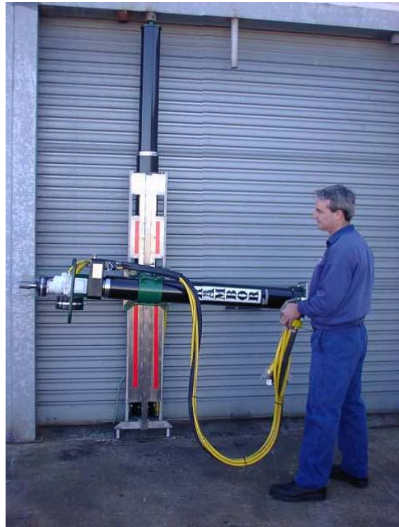
图片显示的为 带行程为1.3 or 1.7 米的两级/双动长壁工作面钻孔机的RDR2
