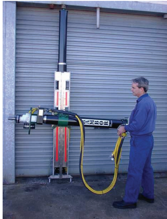
На фотографии показана машина RDR2 с двухсекционным забойным буровым агрегатом Longwall двойного действия с рабочим ходом 1,3 или 1,7 метра
